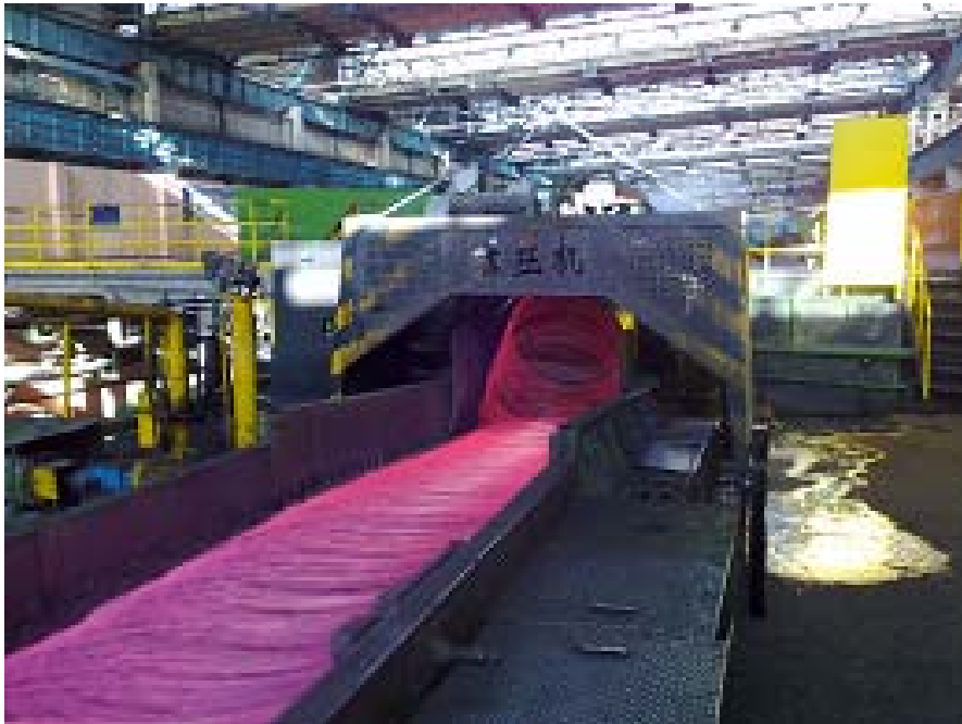
某钢铁公司高速线材生产线，实施80点振动，6个转速在线监测，及离线监测网络化系统
