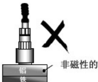
为避免磁性消失，不要**摔或加热**磁座。另一需注意的是不要剥去加速度计和磁座上的螺纹。
