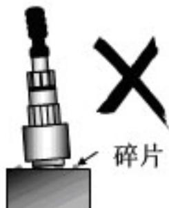
安装表面应当是**真的铁磁性材料**（铁、镍或钴合金）。例如，磁座的安装不应在铝面下放置铁材料而把磁座安放在铝的表面。
